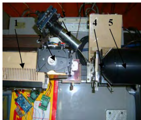
1 – рентгеновская трубка, 2 – сканирующее устройство, 3 – сцинтилляционный детектор, 4- объект, 5 - рентгеновская ПЗС-камера
