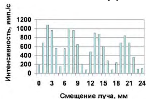
Рисунок 5 – Зависимость интенсивности обратнорассеянного рентгеновского излучения от положения рентгеновского пучка на пластмассовой пластине с прорезями
