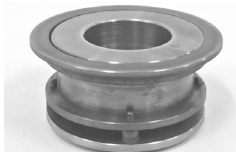
Рисунок 1 – Внешний вид электрода-катада для возбуждения разряда с эффектом полого катода
