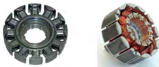
Рис.5. Порошковая заготовка ротора двигателя ABS (слева) и готовый ротор после незначительной мехобработки и обмотки (справа)
