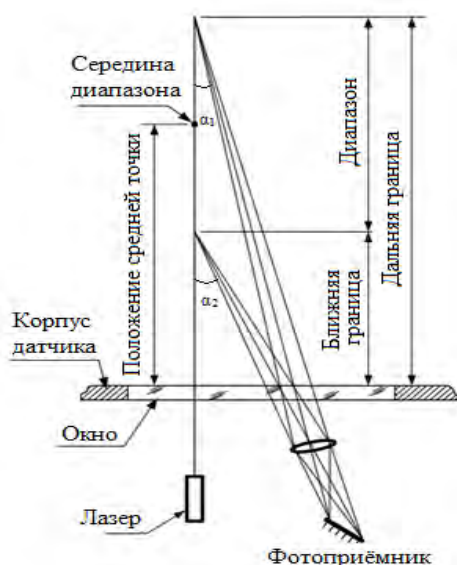
Рисунок 1 – Схема измерения триангуляционным датчиком
