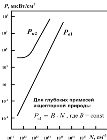
Рисунок 1 – Зависимость границ поддиапазонов энергетической характеристики ФЭП от концентрации примеси акцепторной природы
