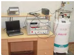
Рисунок 2 – Автоматизированное рабочее место Национального эталона единицы напряжения – вольта № НЭ РБ 10-02
