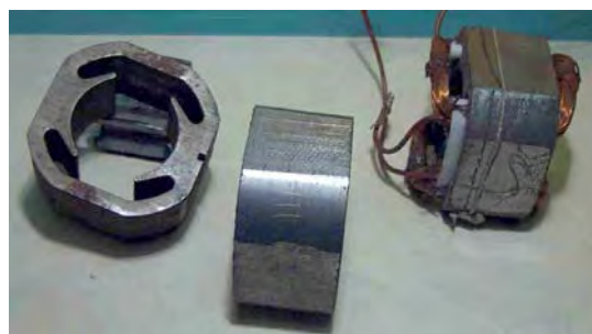
Рис. 1. 3D-дизайн [1] конструкции элементов (ротор-статор) электродвигателя (а) и внешний вид статора из порошковой композиции (б)
