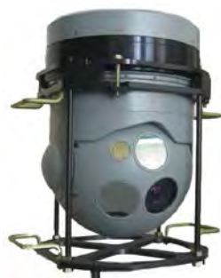
Оптико-электронная система ГОЭС-1 (слева) и беспилотный летательный аппарат «ГРИФ» с установленной системой (справа)
