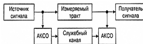
Рисунок 1 – Структурная схема организации измерений без выведения канала из эксплуатации. АКСО – блок аппаратно-программного комплекса
