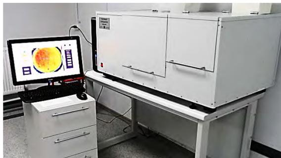
Рисунок 2 – Установка фотостимулированной сканирующей зондовой электрометрии (SPV) «СКАН-2015»
