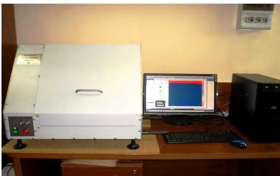
Рисунок 1 – Установка сканирующей зондовой электрометрии (SKP) «СКАН-2013»
