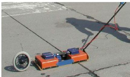
Рис. 2. Антенный блок АБ-400 георадара «ОКО» при обследовании взлетно-посадочной полосы.
