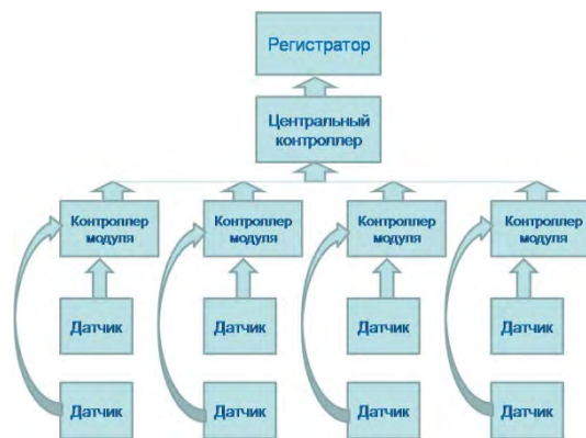
Рисунок 1 – Структурная схема АПК с использованием модулей ФИД
