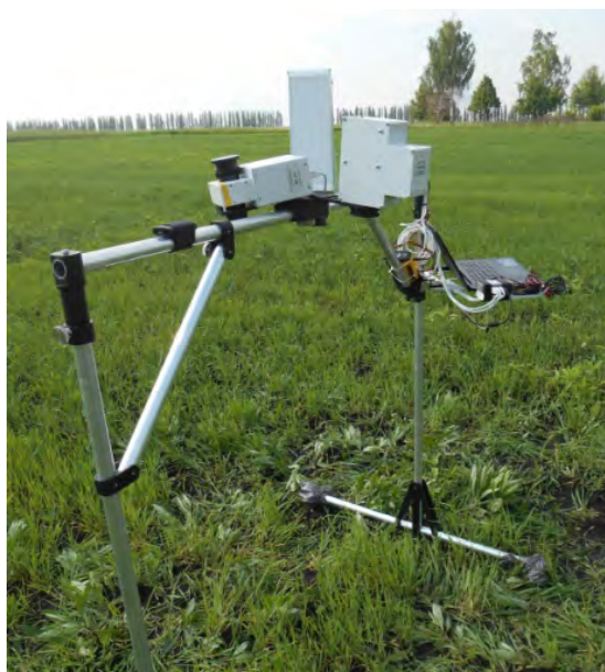
Рисунок 1 – ПСР-700, ПСР-1300, ДМС и управляющий компьютер, установленные на безтеновом полевом штативе (кронштейне), Предварительные натурные испытания АПК «Калибровка» (Курск, май 2016 г.)
