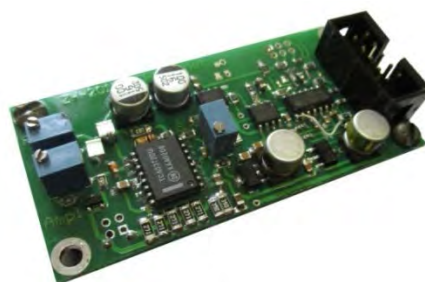
Рисунок 3 – Плата модулятора и фазового детектора-интегратора (совместно с платой предусилителя образует законченный электронный блок измерителя КРП)
