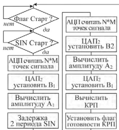
Рисунок 2 – Измерительный алгоритм микропроцессорного зонда Кельвина
