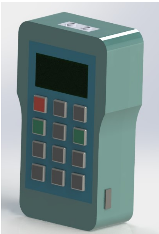
Рисунок.1 – Твёрдотельная модель ультразвукового толщиномера НА-95
