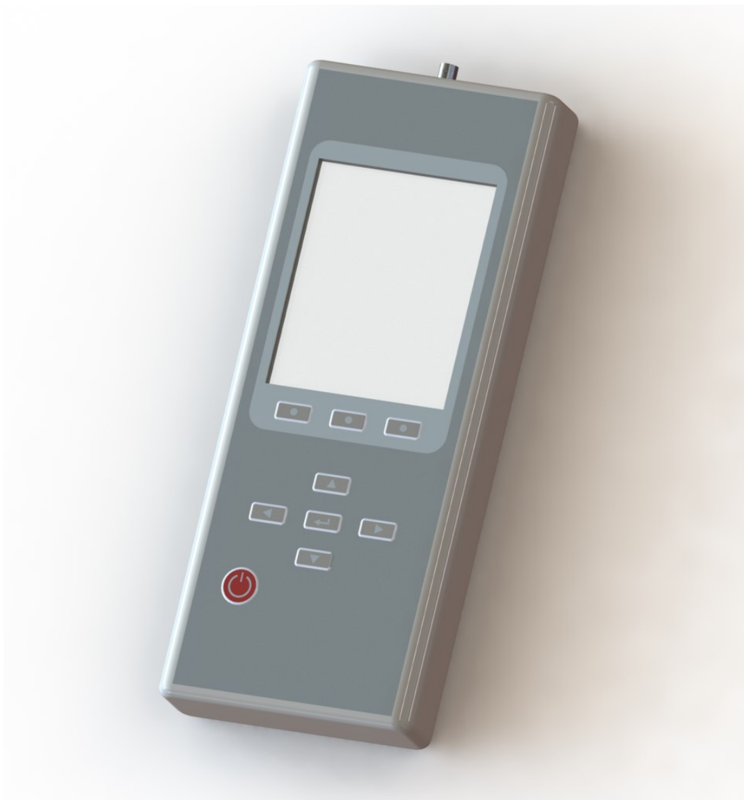
Рисунок 1 – Твёрдотельная модель ультразвукового толщиномера
