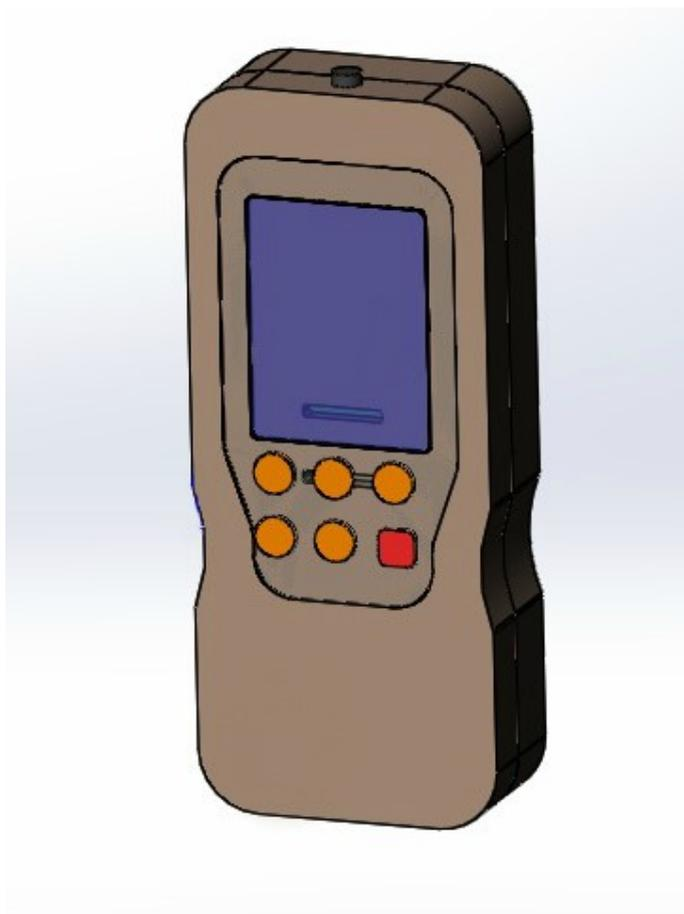
Рис.1 – Трехмерная модель измерителя точки росы
