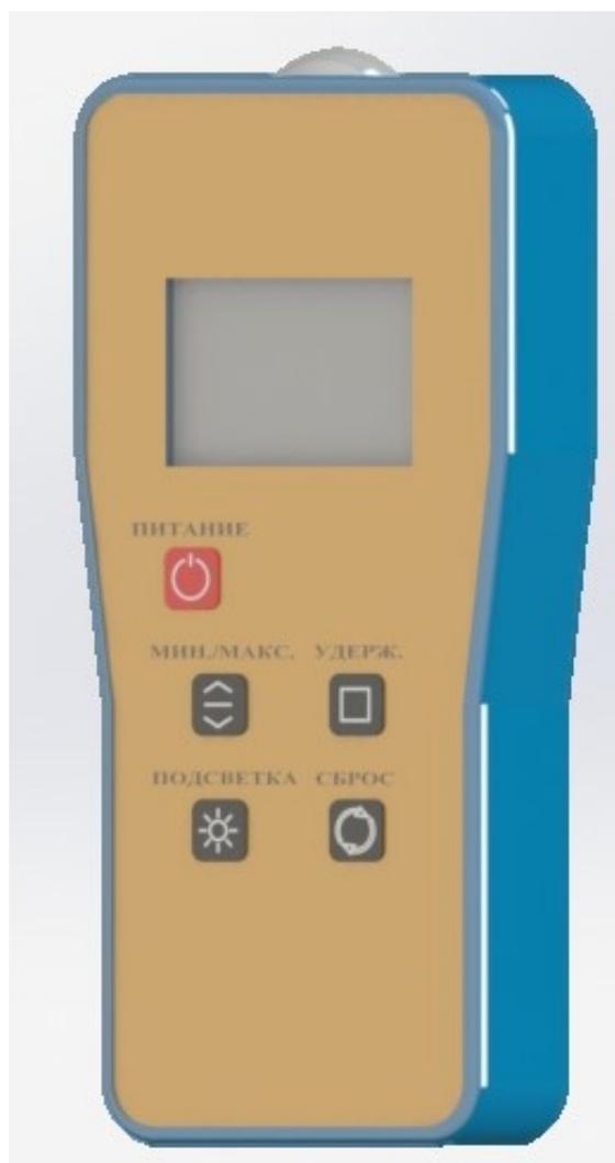
Рисунок 1 – Твердотельная модель люксметра
