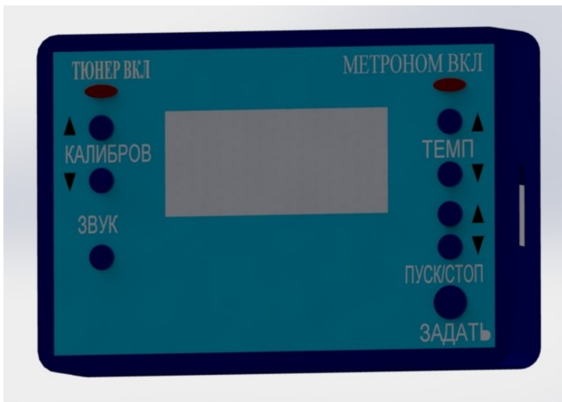
Рисунок 1 – Твердотельная модель тюнера-метронома
