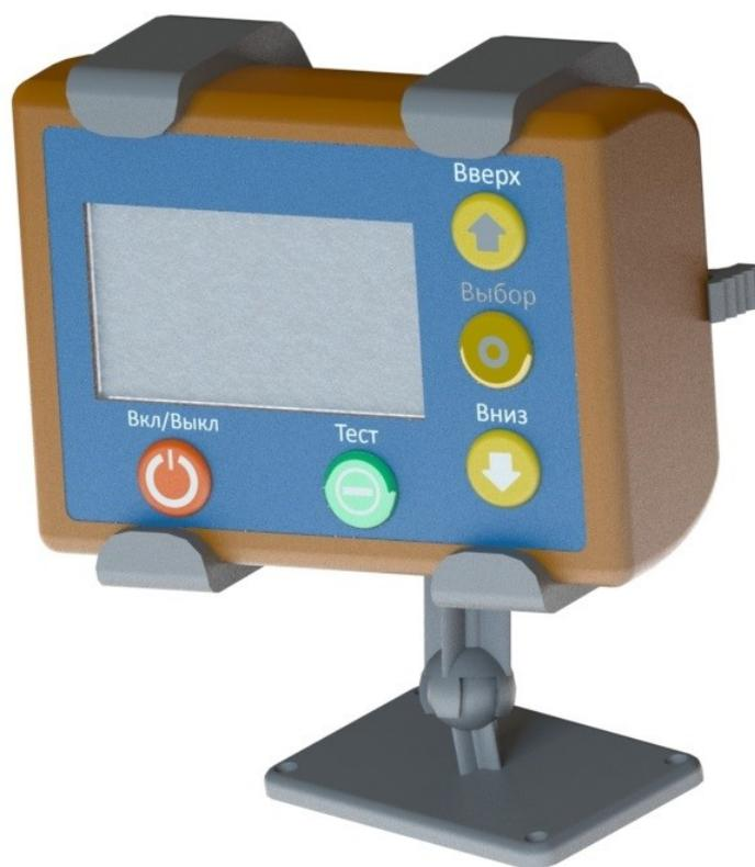
Рисунок 1 – Твердотельная модель электронного блока устройства измерения адгезии,
