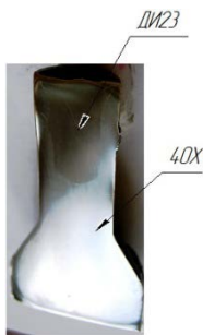
Рис. 1 - Фото продольного шлифа биметаллической детали типа «Выталкиватель»
