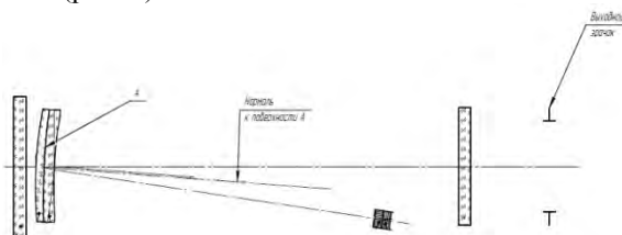
Рис. 1. Оптическая схема коллиматорного прицела
