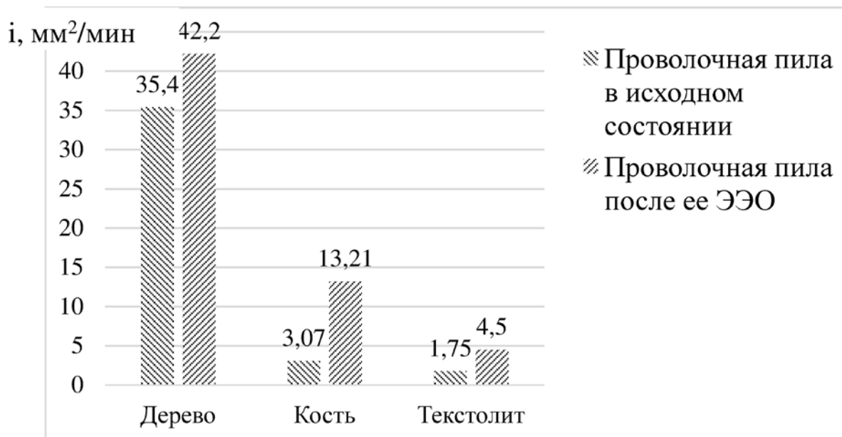
Рисунок 2 – Значение интенсивности распиливания образцов витой проволочной пилой в исходном состоянии и после ее ЭЭО
