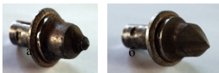
Рис. 1 - Фото резцов после испытаний: а) резец из стали 5ХНМ и наконечником из ВК20; б) резец из стали Д123 и наконечником из стали Р18
