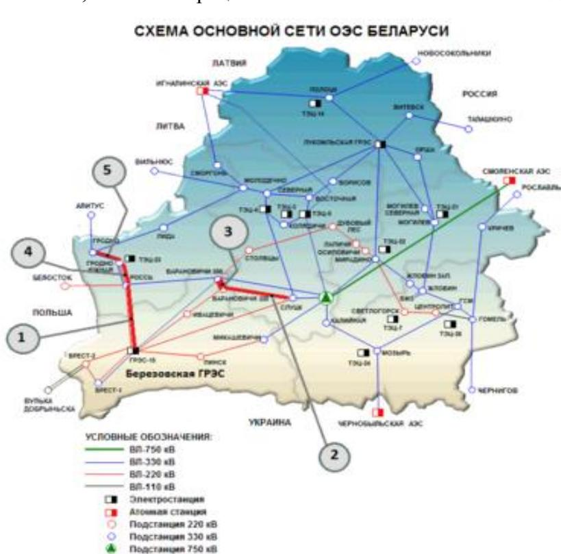
Рисунок 1 – Схема основной электрической сети Беларуси
