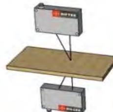
5. Сортировка объектов. Датчики применяются в автоматических сортировочных линиях (пример, сортировка конструктора LEGO) или специальных измерительных стендах. Точность измерения 0,5-0,01 мм
