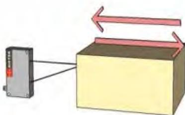
3. Построение 3D-модели (профиля объекта) с помощью специализированных программ. Точность измерения 1,0-0,05 мм.
