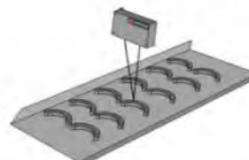
6. Размеры объекта. При перемещении детали (изделия) бесконтактно определяются его размеры. Точность измерения 1,0-0,05 мм
