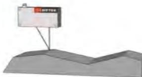
4. Толщина/ширина изделия. Датчики располагают и калибруют в одной системе координат. Точность измерения 0,5-0,01 мм
