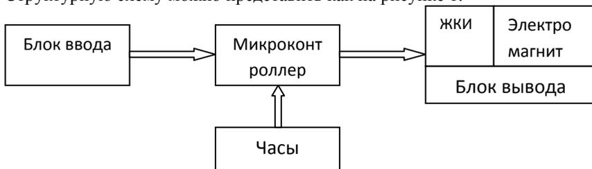
Рисунок 1 – Структурная схема кодового замка.
