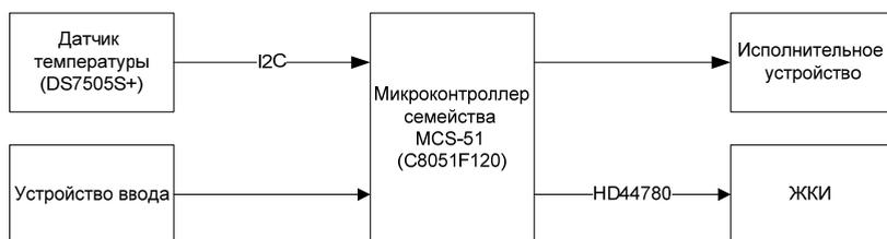
Рисунок - Структурная схема устройства
