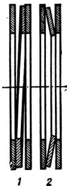
Рис. 4.2. Разновидности коробления дисков фрикциона: 1 – волнистое; 2 – тарельчатое
