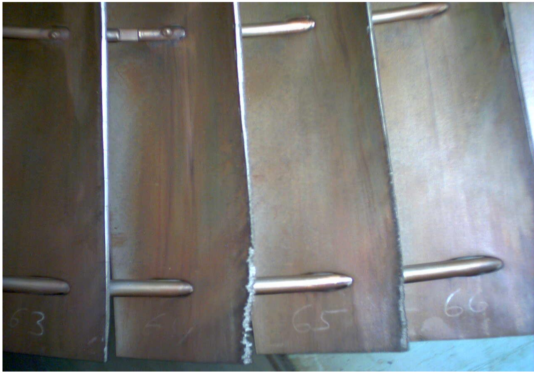
Рисунок 2 – Фактический вид лопатки ЦНД
