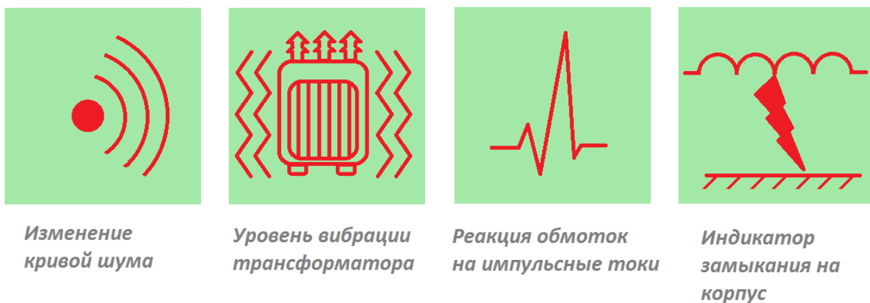
Рисунок 4 – Дополнительные измеряемые характеристики для оценки стойкости трансформатора к токам короткого замыкания
