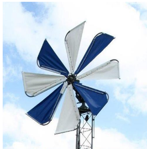
Рисунок 1.2 – Ветрогенераторы с жесткими и парусными лопастями
