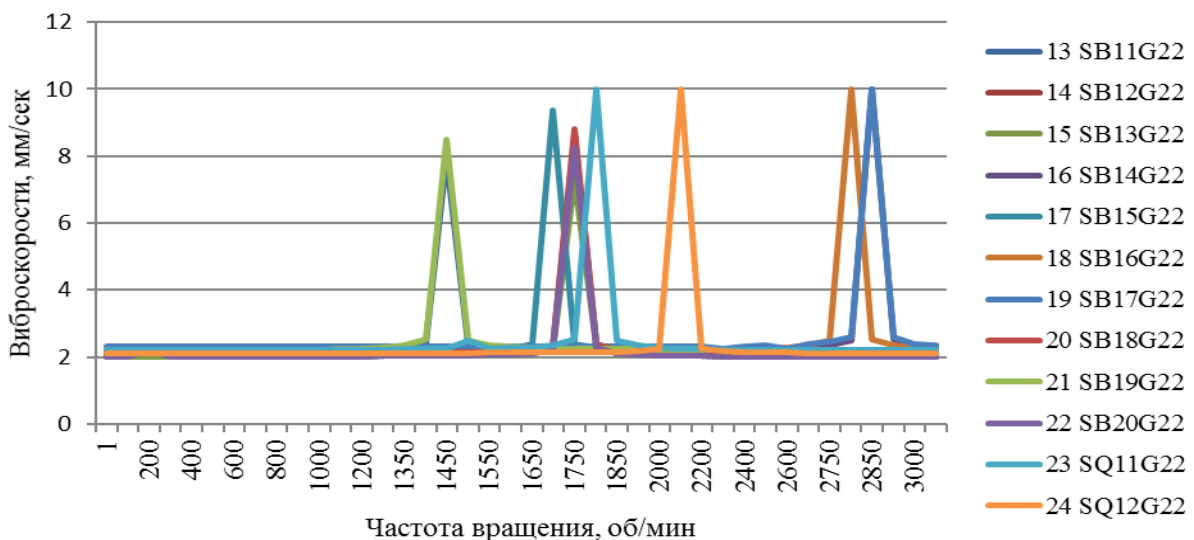
Рисунок 2 – Графики зависимости продольной виброскорости от частоты вращения турбоагрегата
