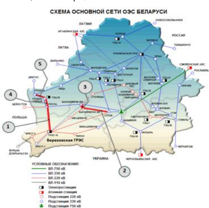
Рисунок 1 – Схема основной электрической сети Беларуси
