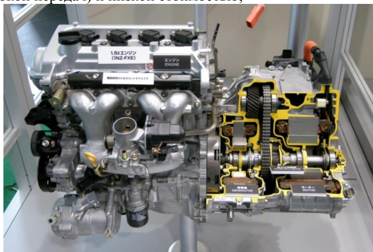
Рисунок 2 Гибридный двигатель параллельного соединения (разрез).
