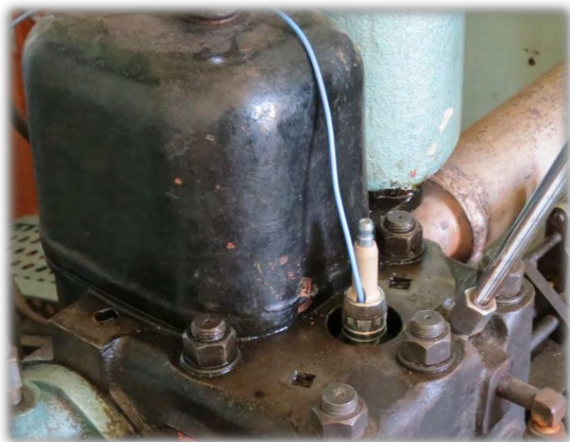
Рис. 5.3 – Место установки пьезодатчика
