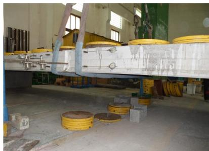
Нагрузка полностью передаётся на стропы крана, которые моделируют среднюю опору
