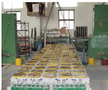
Диск перекрытия, образованный плитами безопалубочного формования и балкой замоноличивания
