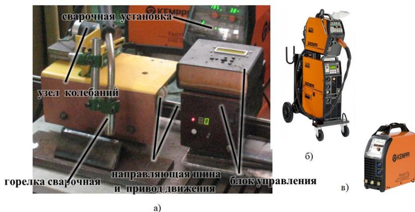
Рис. 2.2.23. Общий вид лабораторного образца автоматизированного мобильного технологического комплекса (а); общий вид сварочных инверторных установок FastMig Pulse 350 (б) и MasterTig MLS 2300 (в)
