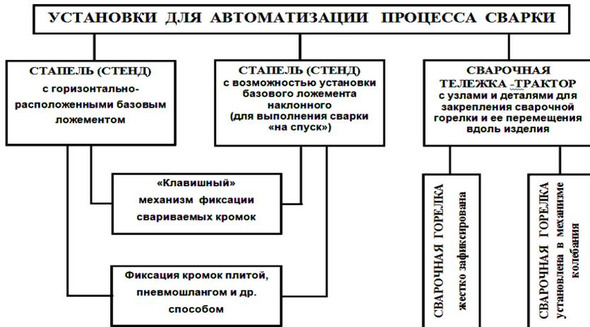
Рис. 2.2.21. Классификация установок для автоматизации сварочных процессов
