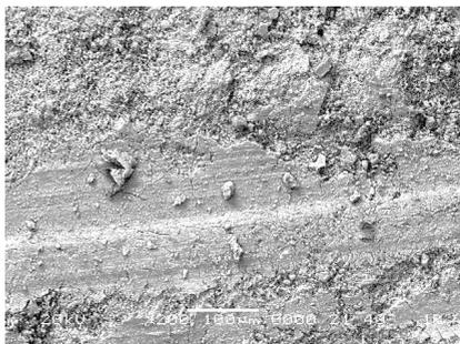
Рис. 2.2.10. Кристаллическая структура образца керамического кирпича, содержащего 15% (масс.) отходов вместо легкоплавкой глины
