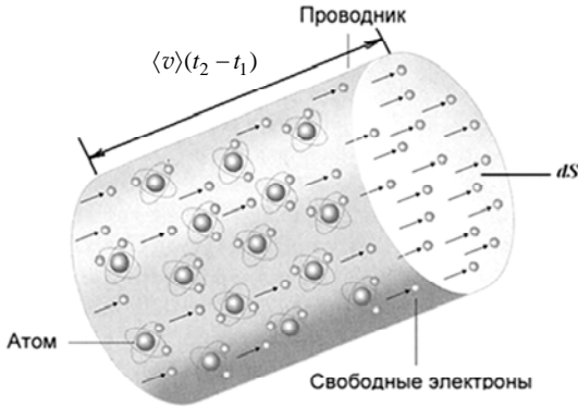
Рис. 18.3. К выводу закона Ома в дифференциальной форме
