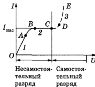
Рис. 19.13. Вольт-амперная характеристика газового разряда
