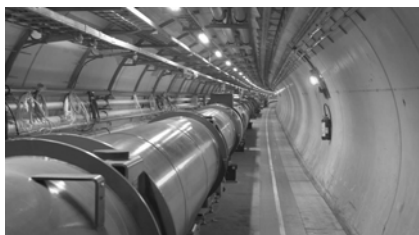
Рис. 20.24. Электромагниты большого адронного коллайдера
