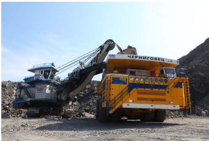
Рис. 4. БЕЛАЗ-75710 грузоподъёмностью 450 тонн
