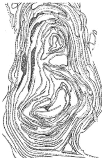
Рис. 2. Схема петлевых автомобильных съездов в карьере
