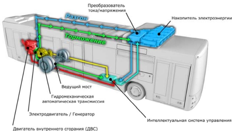
Рис. 10. Гибридная силовая установка городского автобуса
