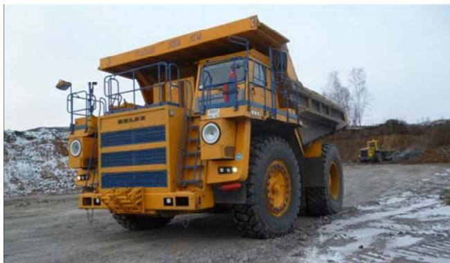
Рис. 2. Самосвал БЕЛАЗ-75581 грузоподъемностью 90 тонн
