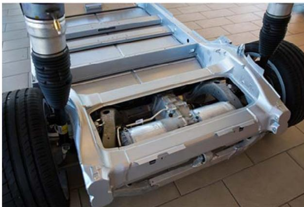
Рис. 4. Установка мотор-генераторов автомобиля компании "Тесла"
