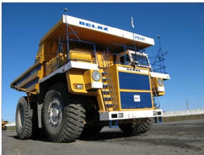
Рис. 3. Роботизированный самосвал БЕЛАЗ г/п 130 тонн
