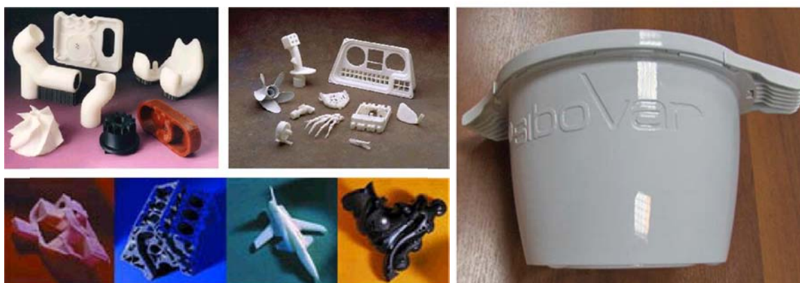
Рисунок 5 – Примеры прототипов, изготовленных из ABS пластика по технологии FDM
