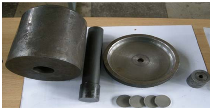
Рисунок 2 – Технологическая оснастка для экструдирования лигатуры из брикетов
