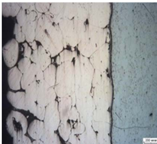
Рисунок 2 – Микроструктура двухслойного материала с неравномерной пористостью (×50)
