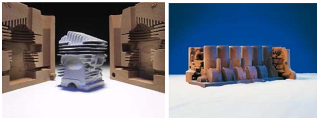
Рисунок 3 – Песчаные формы головки цилиндра и блока цилиндров полученные по SLS-процессу
