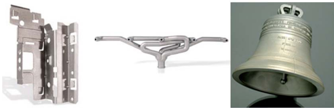
Рисунок 4 – Готовые металлические детали, полученные спеканием металлических порошков
