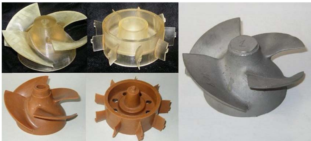
Рисунок 1 – Пример использования стереолитографических моделей для литья по выплавляемым моделям
