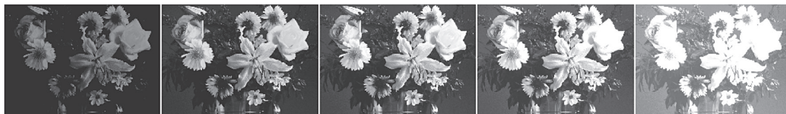
Рис. 4. Тестовое изображение flowers после линейного изменения яркости от -100 до +100 с шагом 25 (в центре исходное изображение)
