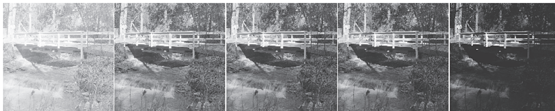
Рис. 1. Тестовое изображение bridge после гамма-коррекции яркости при гамма равном 0.25, 0.75, 1 (совпадает с исходным изображением), 1.25 и 3.3, соответственно
