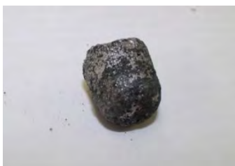
Рисунок 1 – Образец силицида титан-кремний-никель
