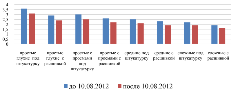
Рисунок 2 – Изменение сменной выработки при выполнении работ по кирпичной кладке стен до и после утверждения результатов нормирования постановлением Министерства архитектуры и строительства Республики Беларусь № 24 от 10.08.2012г., м 3
