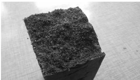
Рис. 4. Поверхность разрушения цементного образца с волокнами ИКТ
