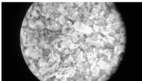
Рис 3. Формовочная смесь, включающая портландцемент с добавкой ИКТ и кварцевый песок
