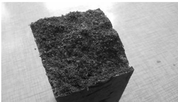
Рис. 4. Поверхность разрушения цементного образца с волокнами ИКТ
