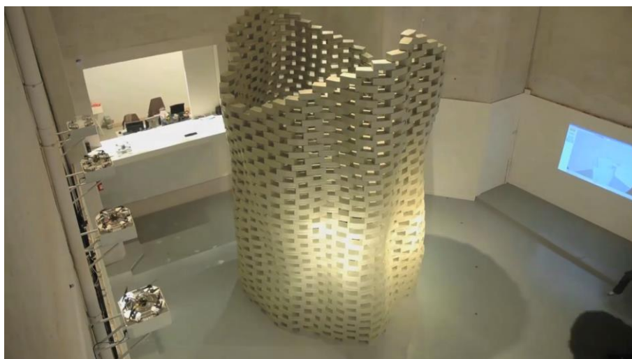
Рисунок – 1 Башня из легких пеноблоков. Демонстрация возможностей БЛА
