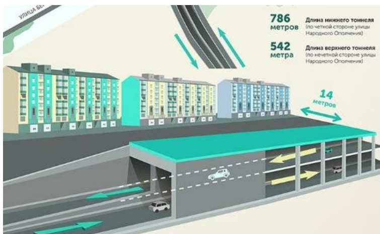
Рисунок 3 – Схематический вид винчестерского тоннеля в Москве
