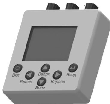
Твердотельная модель цифрового осциллографа
