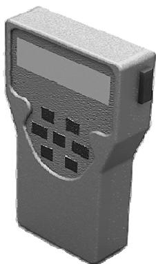
Твердотельная модель измерителя защитного слоя бетона
