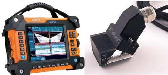
Цифровой ультразвуковой дефектоскоп SUPOR и фазированная решетка.
