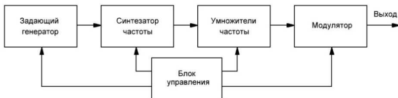
Структурная схема ГКЧ
