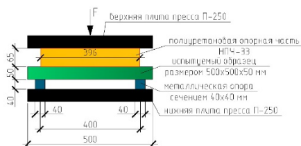
Рисунок 1 – Схема испытания натуральных образцов
