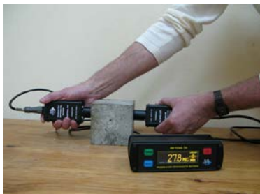
Рисунок 1 – Определение прочности бетона неразрушающим методом
