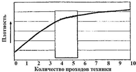
Рис. 5.5. Зависимость плотности ТБО на полигоне от количества проходов уплотняющей техники
