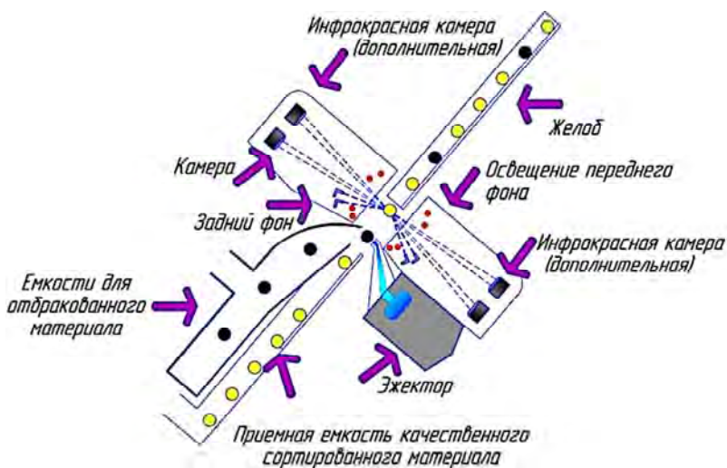
Рис. 2.19. Принципиальная схема работы фотоэлектронного сепаратора
