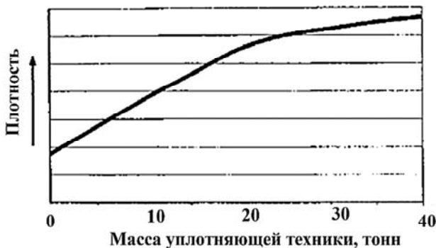
Рис. 5.6. Влияние массы уплотняющей техники на уплотнение ТБО
