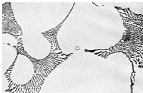
Рисунок 1 – Микроструктура литой быстрорежущей стали. Первичные дендриты окружены сеткой ледебурита
