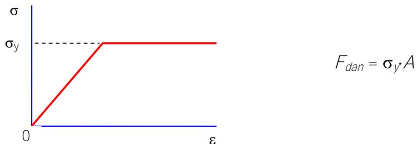
**Рис. 23.** Диаграмма зависимости напряжений и деформаций для упругопластических материалов – диаграмма Прандтля
