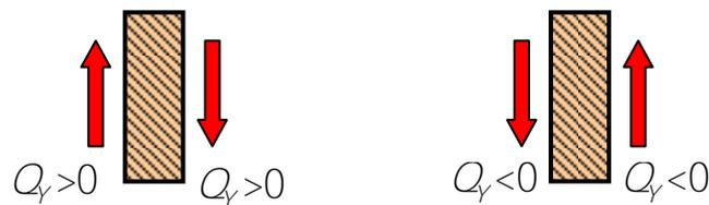
Рис. 44. Правило знаков для поперечных сил в балках
