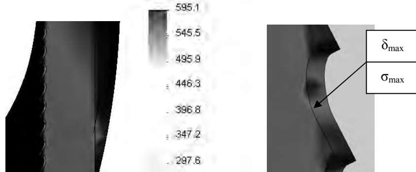
Рис. 2. Распределение деформаций \delta и напряжений \sigma в межзубной впадине на ленточном полотне при действии растягивающих сил
