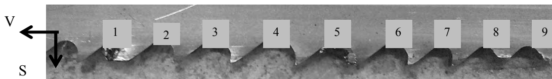
Рис. 4. Сколы и разрушение быстрорежущей части зуба
