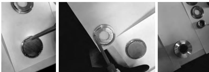
Рис. 5. Поэтапный процесс склеивания фильтра
