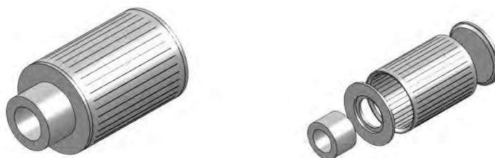
Рис. 4. Сборочная схема щелевого фильтра
