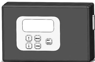
Твердотельная модель фотоэлектрического блескомера
