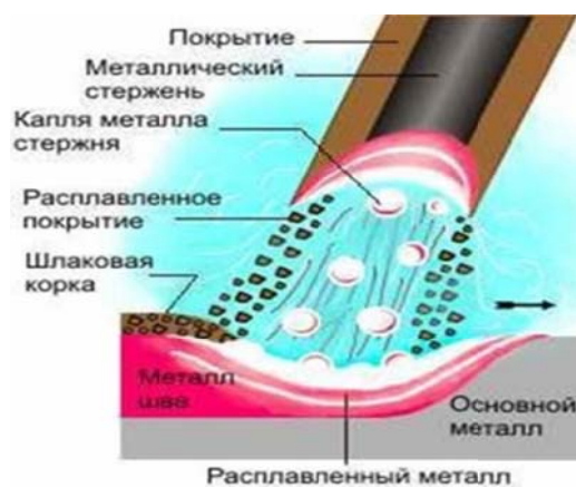
Рисунок 1 – Схема процесса ручной дуговой сварки покрытыми электродами
