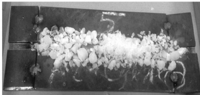
Рисунок 2 – Внешний вид свариваемых элементов под слоем сухого льда
