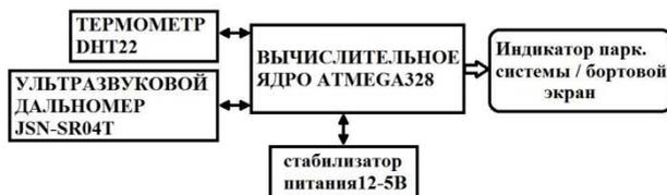
Схема ультразвуковой парк. системы с температурной коррекцией
