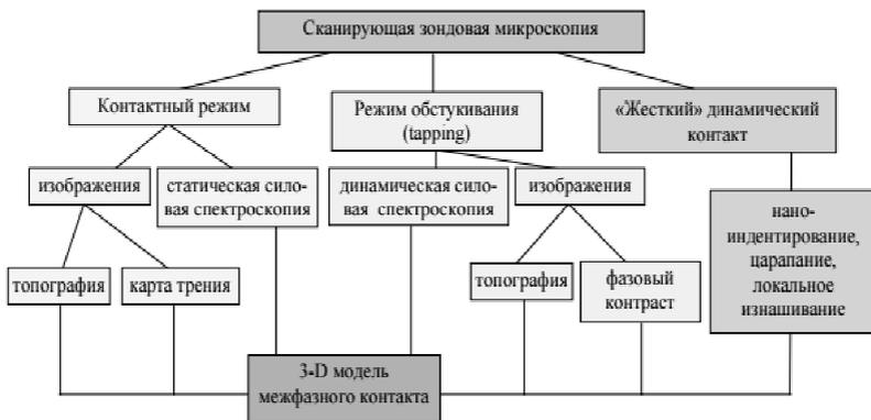
Режимы сканирующей зондовой микроскопии для задач наномеханики и наноматериаловедения
