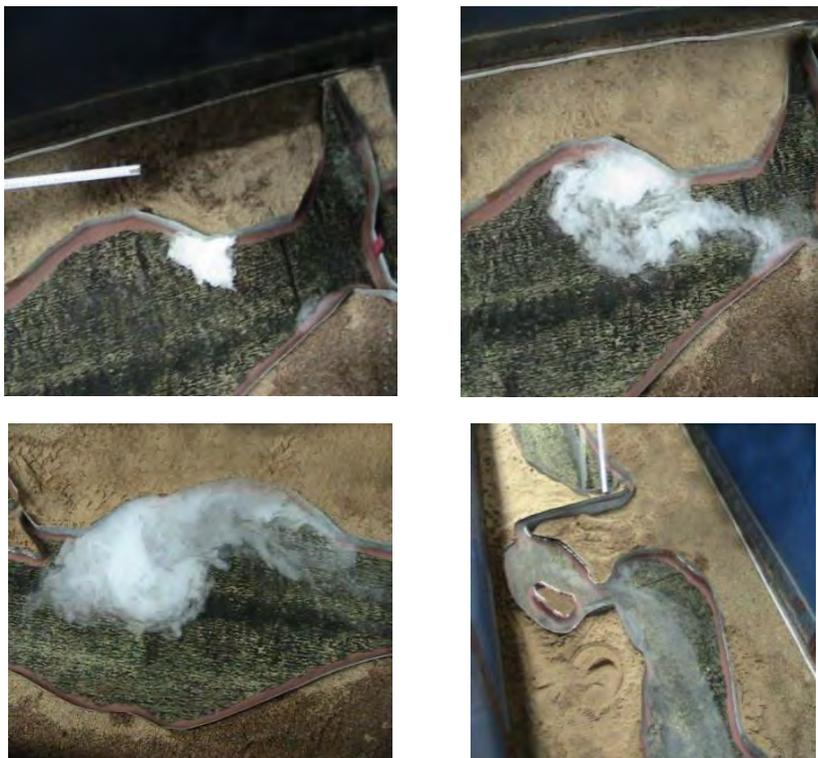
Рис. 3 Перемещение маркера по поверхности модели водохранилища Криницы
